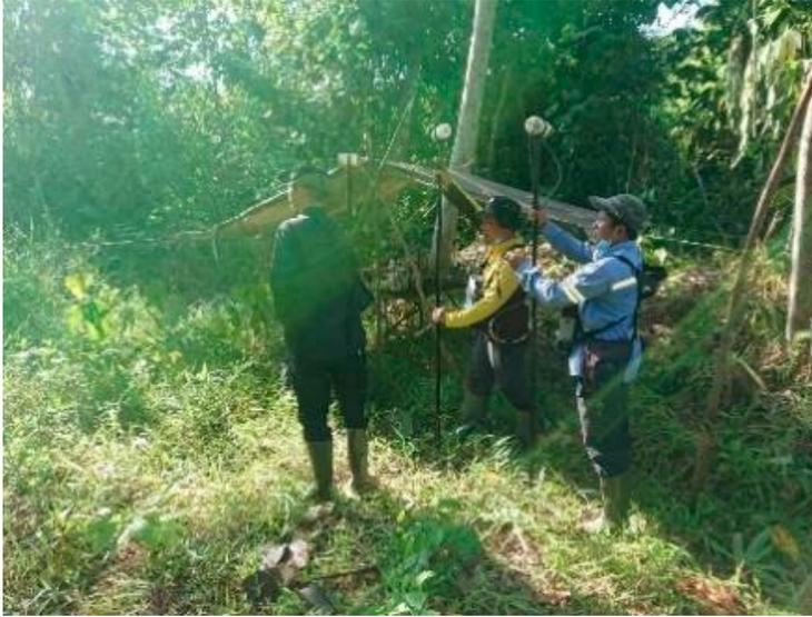
**Gambar 4.12** Akuisisi data geomagnet memerlukan pengukuran medan geomagnet di *base station* (dokumentasi Lab. Eksplorasi Geologi Geotermal ITB di Gunung Tampomas, 2022)
