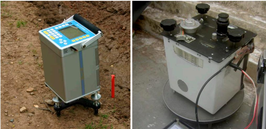
**Gambar 3.4** Instrumen gravimeter yang sering digunakan dalam kegiatan eksplorasi seperti Scintrex CG-5 (kiri) dan La Coste & Romberg seri G (kanan).
